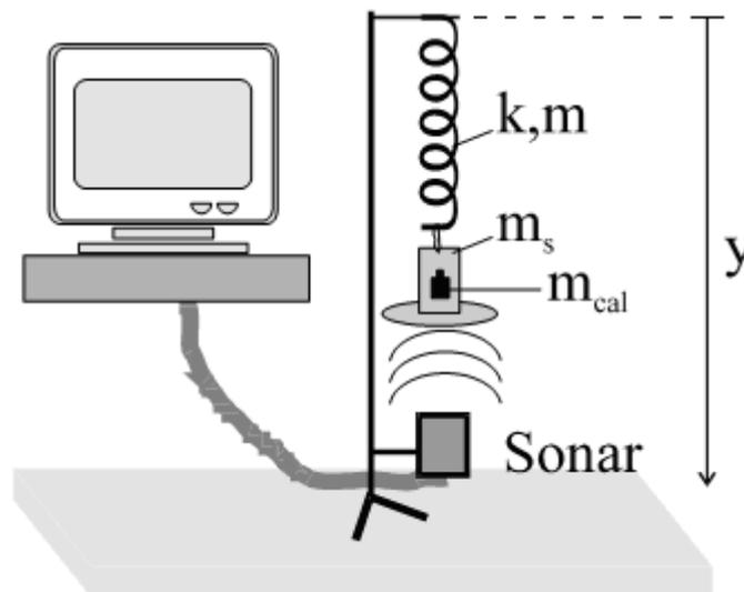
FIG. 1 - Esquema do aparato experimental a ser usado.
